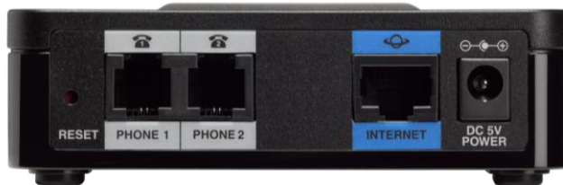
Figura 2. Puertos en adaptador de dos puertos Cisco SPA112 ATA
