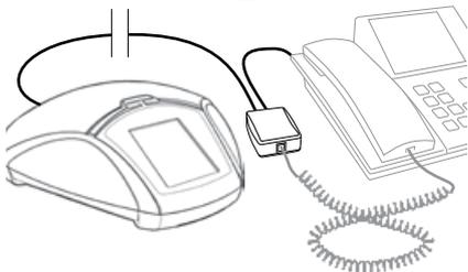
**Desconecte el cable del microteléfono del teléfono y conéctelo al adaptador de teléfono, como en la ilustración.**
